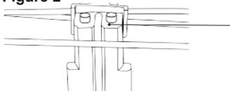
Lubrifiez et insérez le coulisseau pour câbles dans la rainure de l'arbrier
